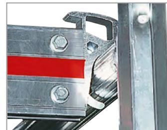
Montaje de la plataforma por un solo operario: los ganchos de seguridad se enganchan incluso en posición abierta
