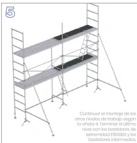
Continuar el montaje de los otros niveles de trabajo según la viñeta 4. Terminar el último nivel con los bastidores de extremidad E1500B3 y los bastidores intermedios.
