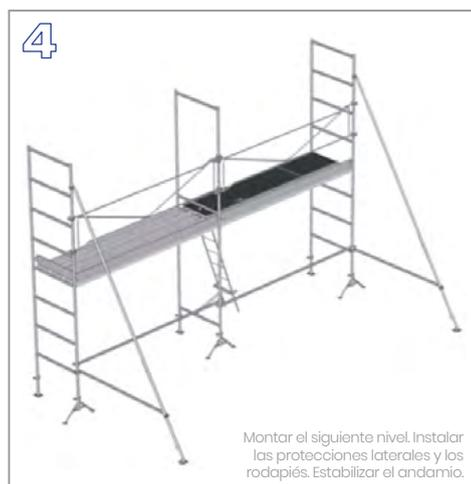
Montar el siguiente nivel. Instalar las protecciones laterales y los rodapiés. Estabilizar el andamio.
