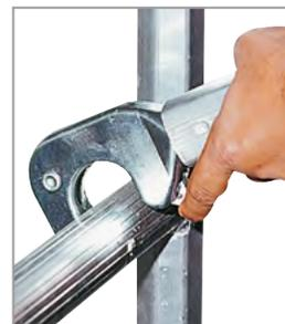
Montaje de la plataforma por un solo operario: los ganchos de seguridad se enganchan incluso en posición abierta
