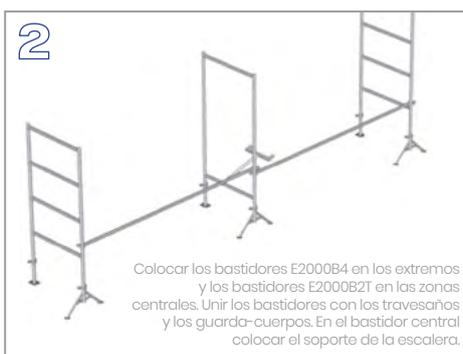
Colocar los bastidores E2000B4 en los extremos y los bastidores E2000B2T en las zonas centrales. Unir los bastidores con los traviesanos y los guarda-cuerpos. En el bastidor central colocar el soporte de la escalera.
