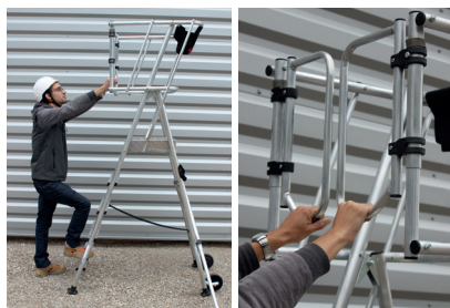
Colocar las manos sobre el portillón de retorno automático
