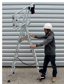
Abrir la plataforma desplazando, hacia el operario, el tramo de soporte
