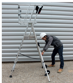
Tirar de los estabilizadores hacia el suelo y bloquear girando de nuevo el tornillo de apriete
