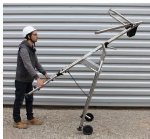
Déplacement en position de travail : en soulevant le plan de montée pour que les roues puissent porter au sol
