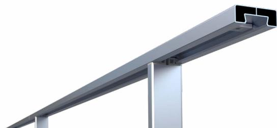
La main-courante du garde-corps FASTGUARD est rectangulaire et continue, elle se fixe au poteau par un système de queue d'aronde, verrouillé en un tour de clé.
