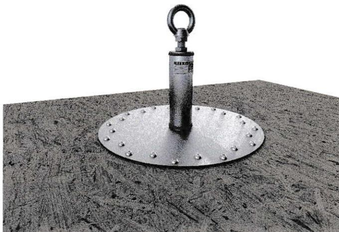
Le test réalisé atteste la résistance de la platine de fixation FLEEX OSB fixée sur un panneau OSB (épaisseur 18mm) grâce à 24 vis à bois M6x30 BHC. Un poteau d'ancrage FLEEX F-A-201 a été utilisé pour réaliser l'essai. L'ensemble a résisté à un effort de 21kN (18kN + 1kN pour chaque utilisateur supplémentaire) pendant 3 minutes, puis a résisté à un effort allant jusqu'à 35kN.
