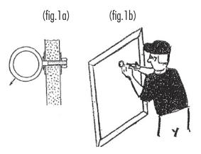
**3** - Après s'être assuré que le mur auquel l'échelle doit être fixée l'échelle est solide et capable de supporter une poussée horizontale une poussée horizontale égale à quatre fois le poids de l'échelle à être à installer (200 kg), insérez l'échelle dans le trou prévu à cet effet. sur le mur (fig.2 vue d'en haut) et fixez-le avec les supports appropriés.
