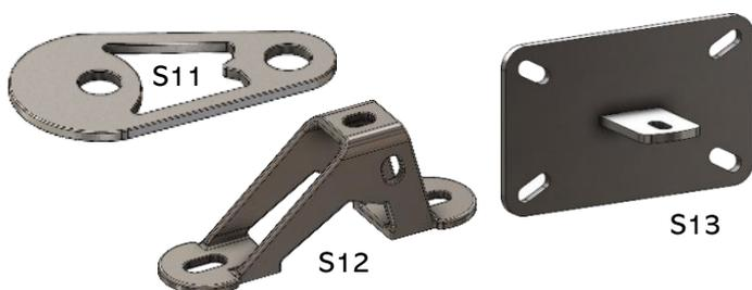
La platine de départ S11 est en inox 304, elle peut être posée sur un potelet. Les platines S12 et S13 sont en acier galvanisé, elles doivent être fixées avec 2 ou 4 fixations M12 inox.
