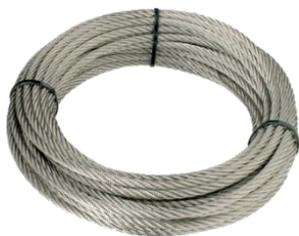
Le câble de ligne de vie Conekt est composé de 7 torons de 19 fils en inox 316.
