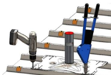
Fixation avec 12 rivets ou 16 vis autoforeuses
