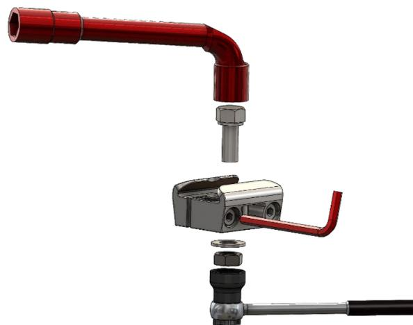
Desserrer les fixations standards R25 à l'aide d'une clé 6 pans 6mm et visser la fixation de rail sur le support par l'intermédiaire d'une clé à cliquet avec douille de 19 et d'une 2<sup>ème</sup> clé de 19.
