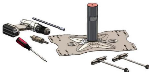
**Ces interfaces CONEKT se posent par l'intermédiaire de 2 ou 4 vis à bascule « papillon ». Ces bascules sont commercialisées en longueur 300 et 500mm, en acier zingué ou en inox 304.**
