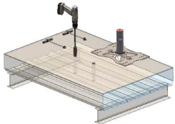
4- Mettre en place les vis à bascule sur la platine avant de les mettre dans le trou pour éviter de les laisser tomber lors du montage.
