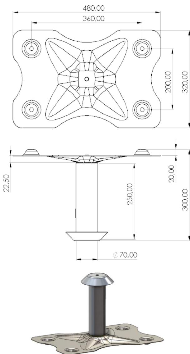
Descriptif : Le potelet basculant PB250 + PB4 répond aux exigences des normes EN 795 Classe A et C.
