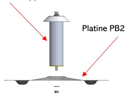
Bien serrer au couple le potelet par l'intermédiaire d'une clé dynamométrique ou d'une boulonneuse.
