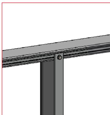
**8** - Vissez les vis 4,8 x 32 sur le montant au niveau de la sous-lisse.
