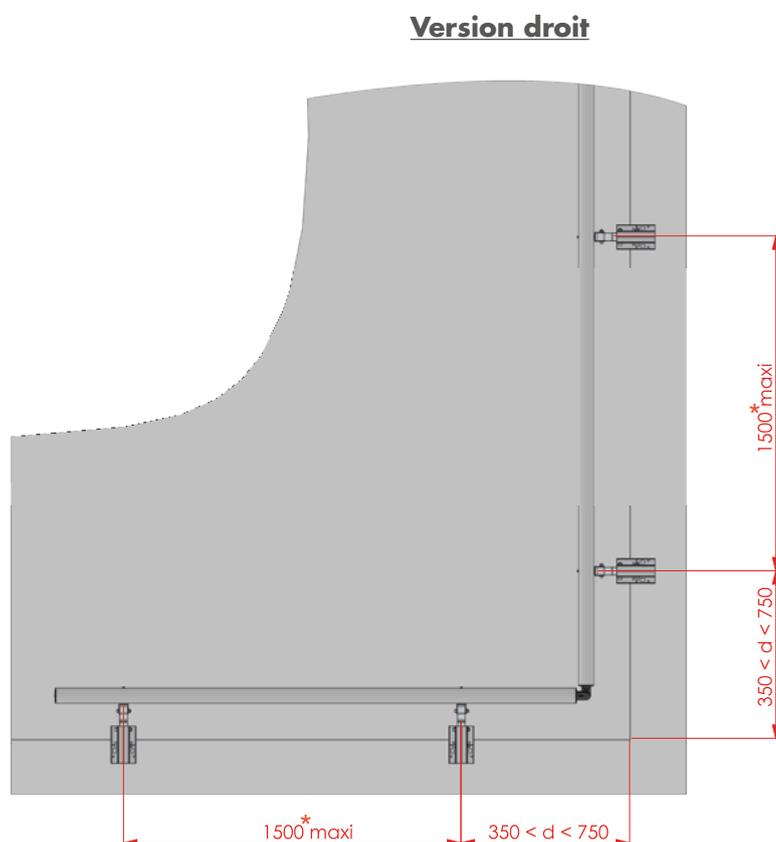
\*En cas de fixation sur sabot Z, en version droite ou inclinée 25°, l'entraxe entre poteaux peut être augmenté jusqu'à 1750 mm maxi, sous réserve de la bonne qualité du support de fixation et de la validation des chevilles selon efforts (voir tableau des efforts).
