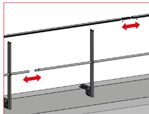
**9** - Assemblez les mains-courantes avec les jonctions et les sous-lisses des tronçons montés. Fixer chaque jonction avec les vis 4,8 x 16 : 2 à chaque jonction de main-courante et 1 entre 2 sous-lisse.
