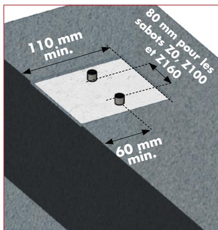
**3** - Les sabots Z doivent être fixés directement sur l'acrotère. Si l'étanchéité le recouvre, découpez à l'emplacement de chaque sabot z.
