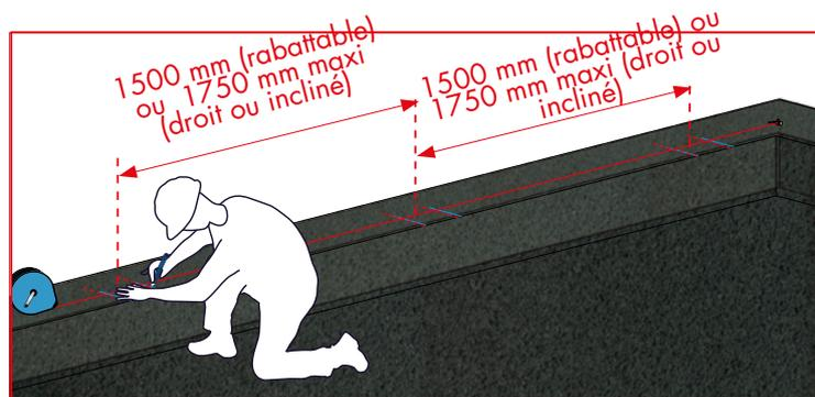
**2** - En cas de sabot Z0, Z100 et Z160, tracez les repères de cotes d'entraxe des fixations de 80 mm à l'aide d'un cordeau.
