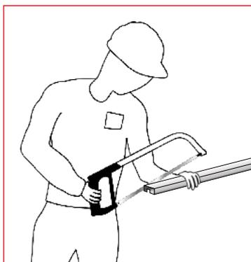
**10** - Ajustez le dernier tronçon en sciant l'excédent rétreint.
