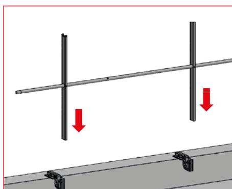
**6** - Placez le tout dans les sabots Z et ajustez la verticalité des montants avec un niveau.
